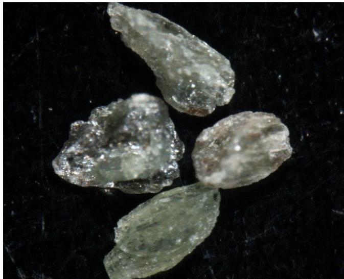
Fig. 3 : Grains de glauconites autochtones naissantes de la cote 6 139 m (fraction 63  $\mu\text{m}$  - 125  $\mu\text{m}$  ; Photo loupe binoculaire).
