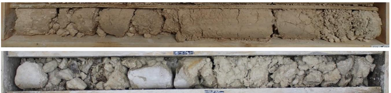
Figure 18 – Faciès superficiels altérés du Calcaire de Saint-Ouen. En haut : faciès altéré homogène plus ou moins meuble. En bas : faciès altéré meuble et fragments résiduels de calcaire dur.
