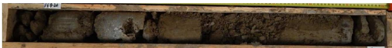
Figure 22 – Faciès altéré sombre atypique du Calcaire grossier observé en profondeur.
