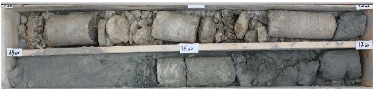
Figure 13 - Carottes de la base du Calcaire de Saint-Ouen au-dessus des Sables de Beauchamp (SB) : banc de calcaire à *Avicula* (C Av), Sables de Mortefontaine (SM) et Calcaire de Ducy (CD).
