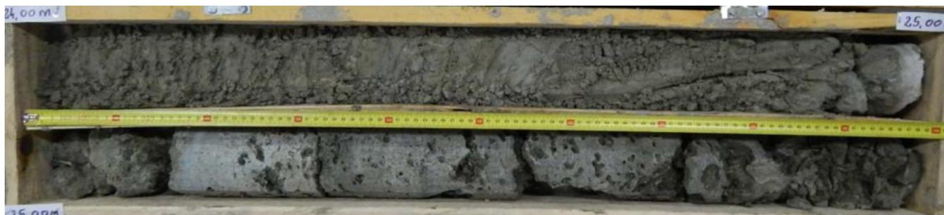
Figure 11 – Intercalation pluridécimétrique de calcaire dur et vacuolaire (carotte du bas) dans un encaissant sableux meuble. Sables de Beauchamp.
