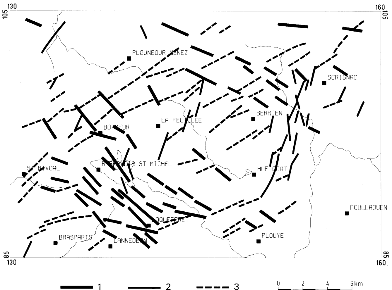
Fig. 8. - Image gravimétrique de la fracturation du granite de Huelgoat montrant le réseau des « discontinuités gravimétriques de fracturation ».
