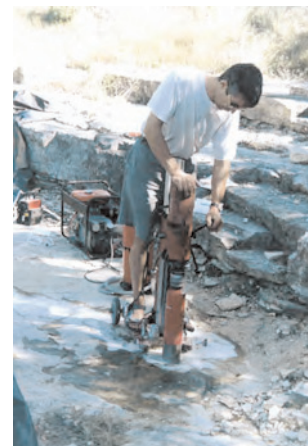
Figure 8 - Travail de carottage du LERM sur la RN du Luberon, dalle à empreintes de pas fossiles de Saignon.
