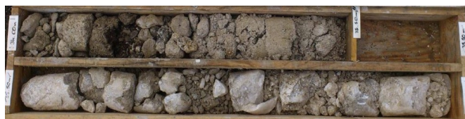
Figure 7 - Exemple de carottes très fragmentées (déstructurées) et plus ou moins altérées vraisemblablement par dissolution du gypse ; en partie inférieure, du gypse alabastré blanc est fragmenté mais encore relativement bien préservé.
