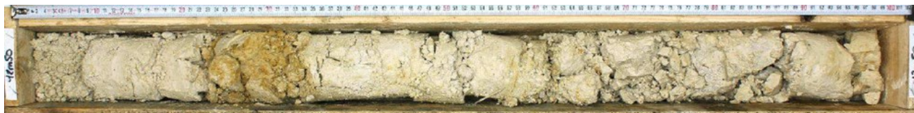
Figure 19 - Faciès superficiel altéré plus ou moins meuble des Marnes et Caillasses.
