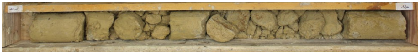
Figure 20 - Faciès superficiel altéré et attendri du Calcaire grossier.
