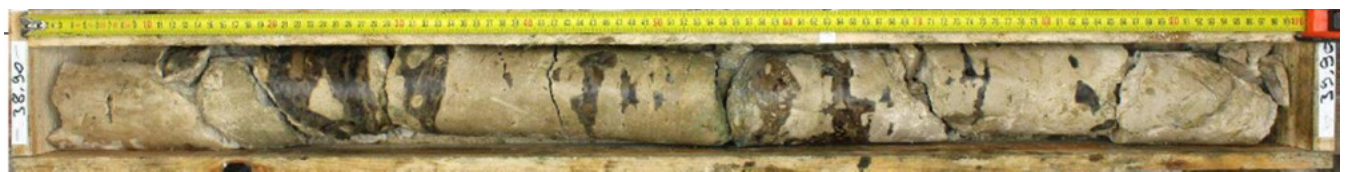
Figure 16 - Calcaire à silex de la formation du Calcaire de Champigny.
