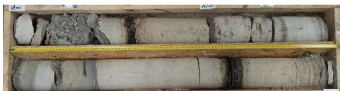
Figure 5 - Marnes et Caillasses : faciès dominant de calcaire gris-beige clair "semi-rocheux" avec intercalations pluricentimétriques/décimétriques (bancs ou fragments) de calcaire dur gris très clair et une intercalation infra décimétrique d'argile marron sombre. L'ensemble est ici globalement massif et très peu altéré.
