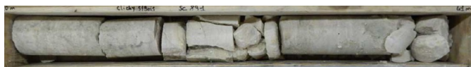
Figure 14 - Carotte de gypse massif au sein des Masses et marnes du Gypse
