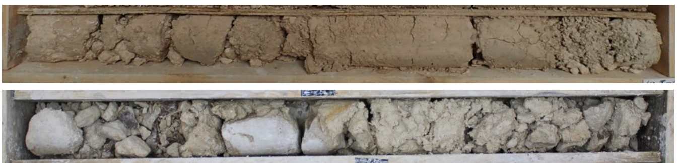
Figure 18 – Faciès superficiels altérés du Calcaire de Saint-Ouen. En haut : faciès altéré homogène plus ou moins meuble. En bas : faciès altéré meuble et fragments résiduels de calcaire dur.
