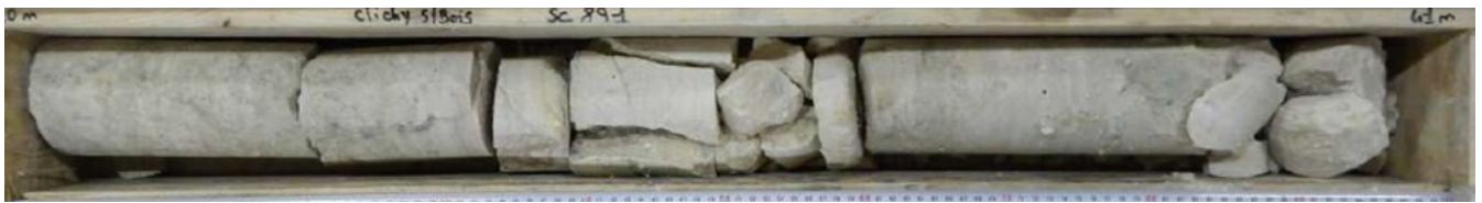
Figure 14 - Carotte de gypse massif au sein des Masses et marnes du Gypse.
