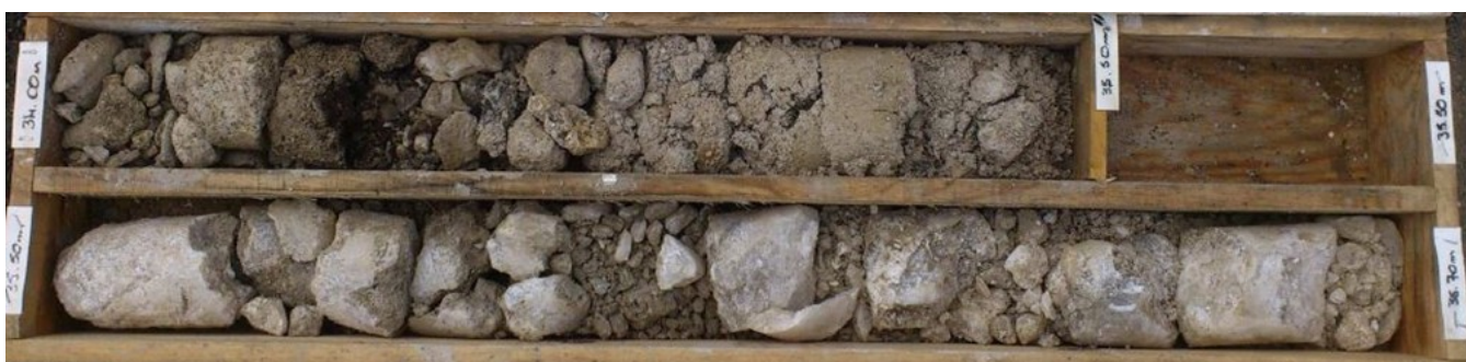
Figure 7 - Exemple de carottes très fragmentées (déstructurées) et plus ou moins altérées vraisemblablement par dissolution du gypse ; en partie inférieure, du gypse alabastré blancâtre est fragmenté mais encore relativement bien préservé.
