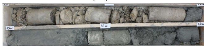
Figure 13 – Carottes de la base du Calcaire de Saint-Ouen au-dessus des Sables de Beauchamp (SB) : banc de calcaire à Avicula (C Av), Sables de Mortefontaine (SM) et Calcaire de Ducy (CD).
