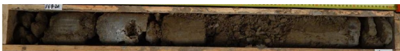
Figure 22 – Faciès altéré sombre atypique du Calcaire grossier observé en profondeur.
