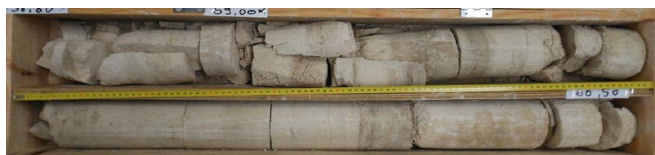
Figure 12 - Carotte de calcaire de Saint-Ouen "semi-rocheux" préservé de l'altération prélevée en profondeur.
