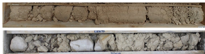
Figure 18 – Faciès superficiels altérés du Calcaire de Saint-Ouen. En haut : faciès altéré homogène plus ou moins meuble. En bas : faciès altéré meuble et fragments résiduels de calcaire dur.
