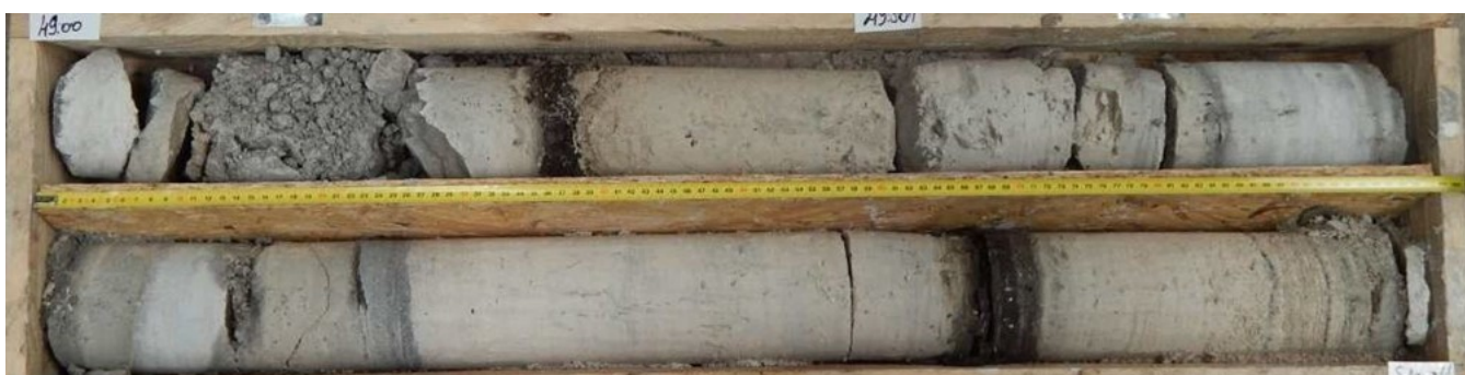
Figure 5 - Marnes et Caillasses : faciès dominant de calcaire gris-beige clair "semi-rocheux" avec intercalations pluricentimétriques/décimétriques (bancs ou fragments) de calcaire dur gris très clair et une intercalation infra décimétrique d'argile marron sombre. L'ensemble est ici globalement massif et très peu altéré.
