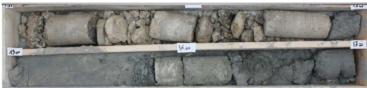
Figure 13 - Carottes de la base du Calcaire de Saint-Ouen au-dessus des Sables de Beauchamp (SB) : banc de calcaire à Avicula (C Av), Sables de Mortefontaine (SM) et Calcaire de Ducy (CD).
