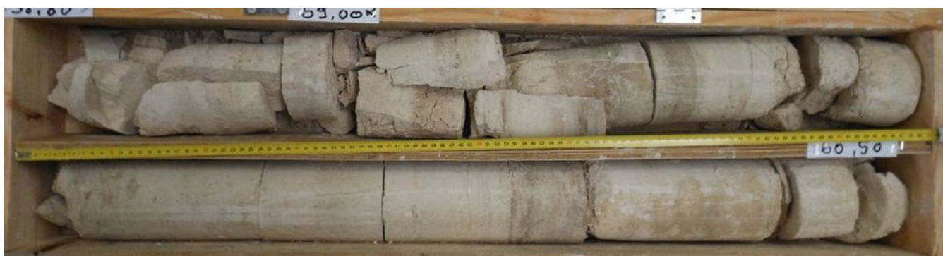
Figure 12 - Carotte de calcaire de Saint-Ouen "semi-rocheux" préservé de l'altération prélevée en profondeur.
