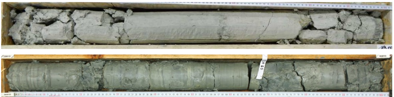
Figure 17 - Exemples de carottes de Marnes bleues d'Argenteuil (en bas) et de Marnes blanches de Pantin.
